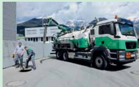
Die Freudenthaler Saugtankwagenflotte deckt nahezu jede Anforderung vom Fettabscheider bis zur Absaugung des Schwimmbadfiltersandes ab.
