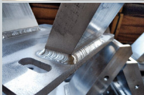
Alu-Schweißarbeiten Rollbob Zams.
