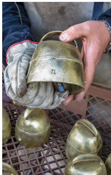
Glänzend wie ein neuer Schilling oder eben eine neue Schelle: Der Messingüberzug macht das Endergebnis perfekt.
