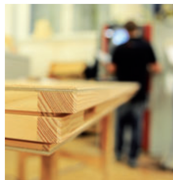
Falze wie diese werden heutzutage CNC-gefräst
